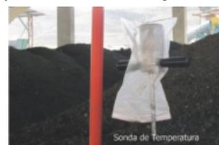
Control de temperatura en el proceso de compostaje.
